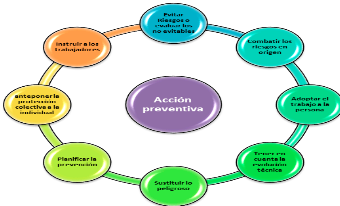
Gráfico 2.7. Principios de acción preventiva para aplicar las medidas concretas de la Ley 31/1995.
